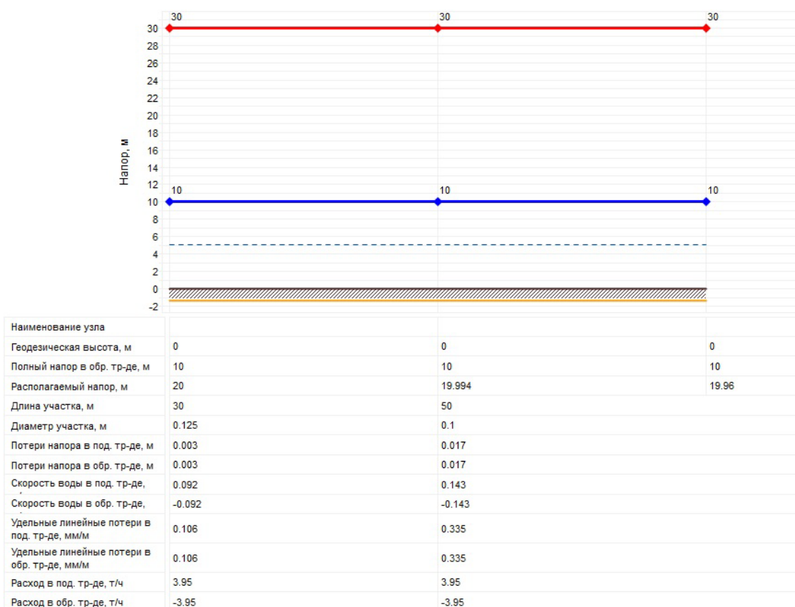
Рисунок 2.40 – Пьезометрический график от источника теплоснабжения (Котельной ТКУ-1 с. Кичигино) до самого удаленного потребителя в аварийной ситуации
